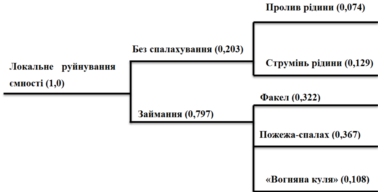
Рисунок 1 – Аналіз розвитку НС на АЗС внаслідок руйнування ємності за допомогою «дерева подій» [3]
