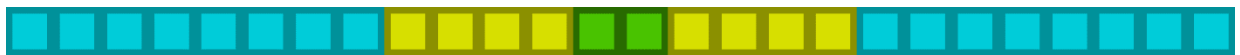
Рисунок 1. Глобальний згортковий фільтр загальної довжини 26. Кожен під-фільтр зображено різним кольором. Кількість параметрів у одному під-фільтрі – 2. Сумарна кількість параметрів – 10 (5 під-фільтрів по 2 параметри).
