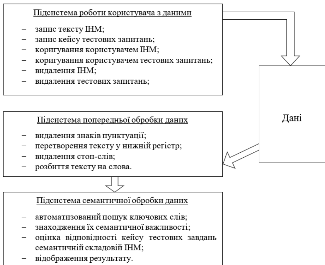
Рисунок 2.4 – Схема інформаційної системи оцінки відповідності кейса тестових завдань семантичній складовій навчальних матеріалів
